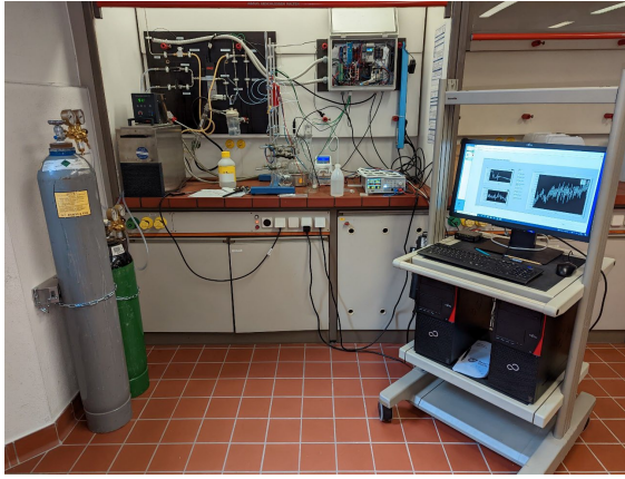
Abbildung 28: Prototyp des CO 2 -zu-Ameisensäure-Elektrolyseurs
