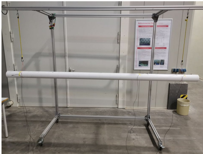
Abbildung 35: Frei aufgehängtes Abwasserrohr mit montierten Beschleunigungsaufnehmern
