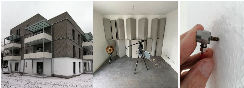
Abbildung 7: Akustikforschung im Holz-Beton-Hybridbau. Messung der Nachhallzeit mit Absorbern bzw. Messung der Schnellepegel auf bereits tapezierten Oberflächen
