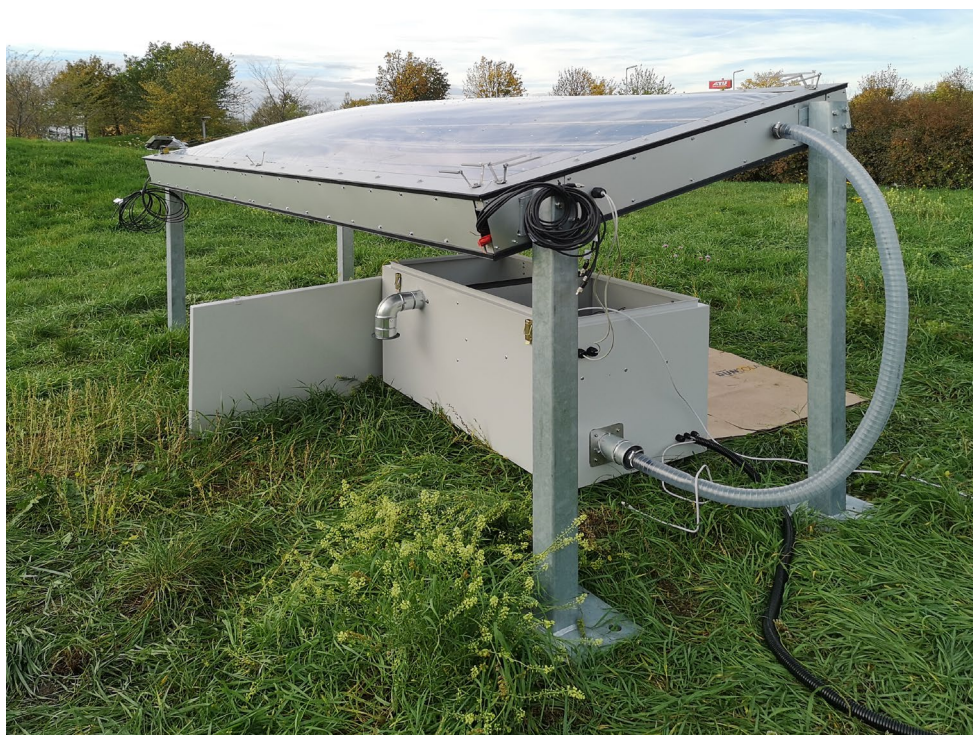
Abbildung 16: Evo-control 2.0 - ETFE-Kissen, beispielhafter Testaufbau im Maßstab 1:1 (Quelle: Hansjörg Zabel/ ITF)
